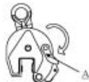
2. Fissare saldamente il gancio sulla lamiera, in modo che il morso del gancio sia posizionato completamente sulla lamiera.
