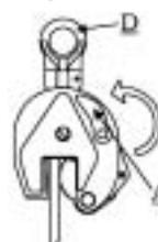
4. Dès que la charge est arrivée à destination, laissez descendre le crochet de grue suffisamment loin de manière à enlever toute charge de la pince, c'est-à-dire que la chaîne de levage ne soit plus tendue et que l'œil de levage (D) de la pince soit entièrement libre de mouvement. Tirez ensuite le blocage de sécurité (A) vers la mâchoire, la pince est alors ouverte et reste ouverte.
