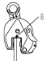
3. Haal nu de veiligheidsgrendel (A) naar het hijsoog (D) toe. De klem sluit nu en blijft op de plaat staan in voorgespannen positie, waarna met het hijsen begonnen kan worden.
