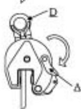
5. La garra puede volver a utilizarse directamente o puede dejarse en posición abierta. Esta posición evita que se dañen los dientes.
