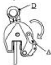
5. De klem kan nu direct weer gebruikt worden of in geopende positie opgeborgen worden. Deze positie voorkomt beschadiging van de tanden.
