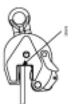
3. Leve em seguida o bloqueio de segurança (A) à alça de içamento (D). A mandíbula estará então fechada e permanece na chapa em estado pré-carregado (protendido), com o que pode ser iniciado o içamento.
