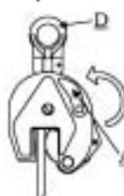
4. Cuando se haya llegado con la carga al lugar de destino, bajar el gancho de elevación lo suficiente, hasta que la garra esté libre, es decir, que la cadena no está tensa y la anilla de elevación (D) de la garra pueda moverse libremente. Lleve ahora el gatillo de seguridad (A) hacia la boca, de forma que la garra se pueda abrir y dejar abierta.
