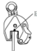
3. Nun den Sicherheitshebel (A) in Richtung Tragring (D) drehen. Die Klemme schließt sich jetzt und bleibt in der vorgespannten Position auf dem Blech stehen. Nun kann mit dem Heben begonnen werden.
