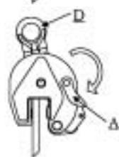
5. La pince peut être directement réutilisée ou être stockée dans la position ouverte. Cette position permet d'éviter tout dommage aux dents.
