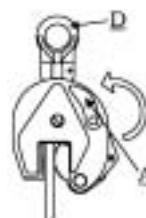
4. Sobald die Last am Bestimmungsort angekommen ist, den Kranhaken weit genug sinken lassen, so dass die Klemme völlig unbelastet (d. h. die Hubkette nicht mehr gespannt) ist und sich der Tragring (D) der Klemme völlig frei bewegen kann. Nun den Sicherheitshebel (A) in Richtung Maul drehen, wodurch die Klemme geöffnet wird und geöffnet stehen bleibt.
