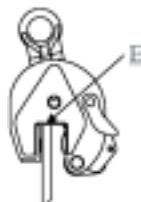
3. Levante el gatillo de seguridad (A) hacia la anilla de elevación (D). La garra se cierra y la chapa queda enganchada, por lo que se puede comenzar la elevación.
