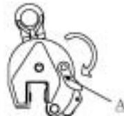
2. Die Klemme fest so auf das Blech setzen, dass der Maulgrund (E) der Klemme ganz auf dem Blech aufliegt.
