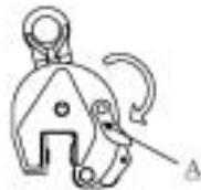
2. Coloque la garra sobre la chapa, de tal forma que la boca sujeté la chapa (E).
