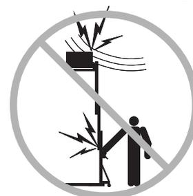
Halten Sie sich fern von der Maschine, wenn sie Strom führende Leitungen berührt. Die Maschine darf nicht von Personen berührt oder in Betrieb genommen werden, bevor elektrische Leitungen abgeschaltet sind.
